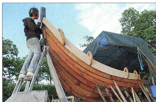
Tilpasning af stævnbord i øverste bordgang
