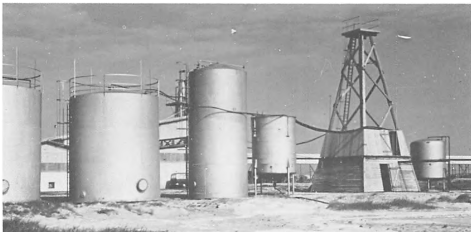
Fig. 26: Salthorsten ved Harboør har være udnyttet. Saltudvindingsanlæg (boretårn med rensentanke) ved Cheminova, Rønland. (DGU/HØ – juni 1960).
