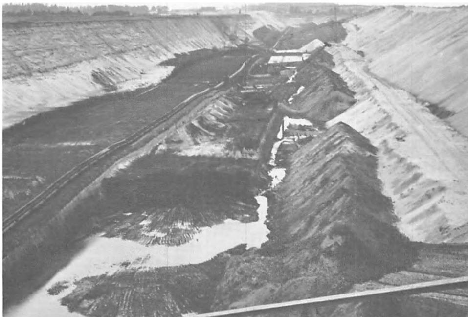
Fig. 35: A/S Carl Niensens brunkulsgrav ved Fæsterholt, sydøst for Herning. Graven er omkring 1 km lang, 80 m bred og 30 m dyb. Den brunkulsførende lagserie overlejres af smeltvandssand fra sidste istid. (B.E. Koch 1968).
