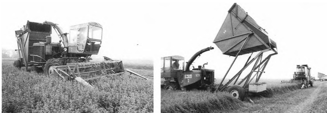
Den kombinerede mejemaskine og snitter. Her klar til tipning i bil.
