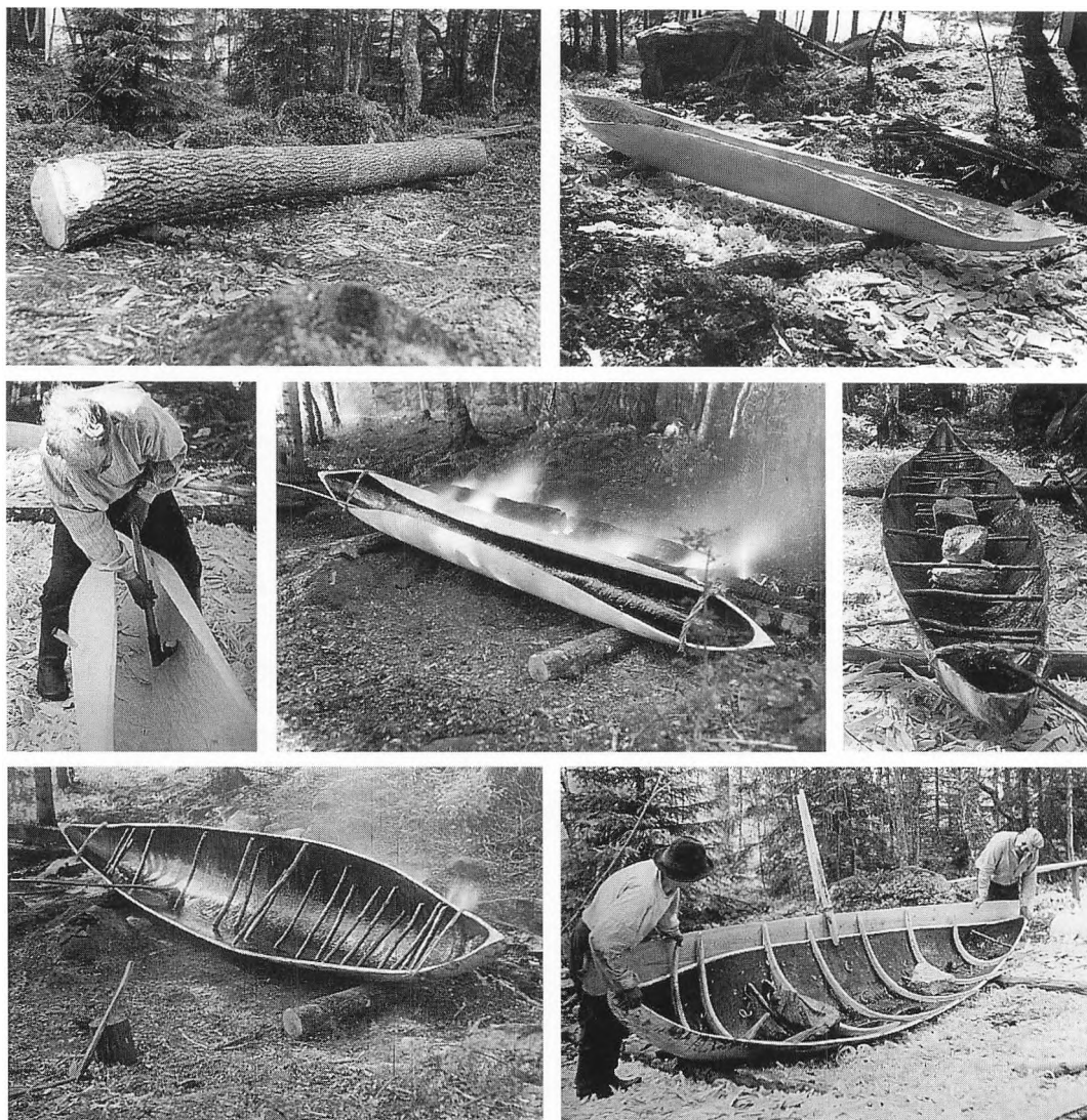
Fig. 5. Stadier i bygningen af en haapio, esping, i Satakunta, Finland i 1935. Her er båden lavet af en relativ tynd aspestamme, der ikke kan give båden tilstrækkelig bredde og sidehøjde uden hjælp af et ekstra bord i hver side. Med en tykkere træstamme kan den endelige bådform imidlertid fås alene ud fra den bælgform, som stammen udhugges med. Foto Finlands Nationalmuseum.
