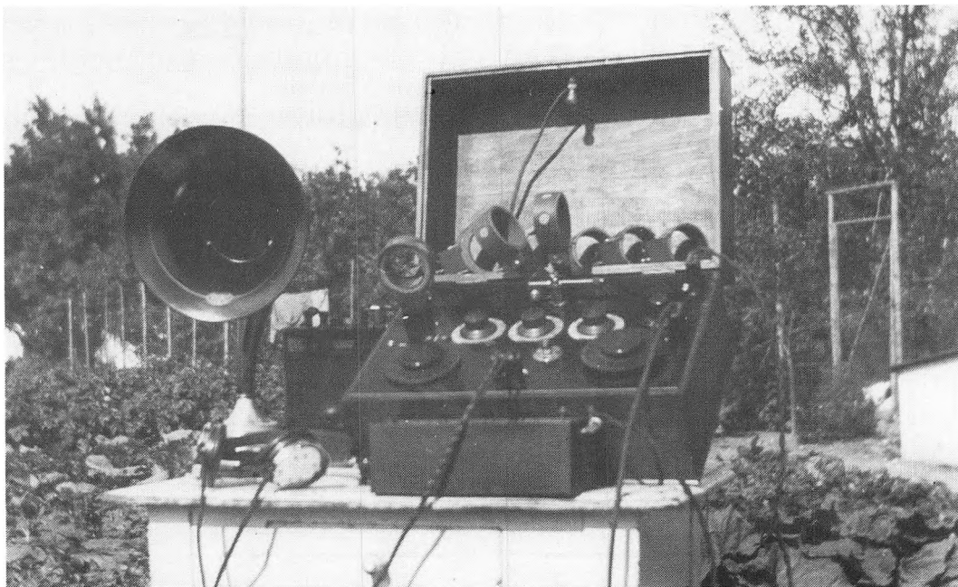
Tragthøjttaleren, der forårsagede den store fiasko, men ellers var god nok, da den blev rensset for træuld, sammen med det øvrige radioanlæg, der var forsynet med 4 indbyggede lamper og tilbagekobling med finindstilling.
