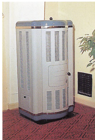
En moderne Hess-ovn, nemlig en olie-kamin, fotograferet i 1955. Den kunne fås i dueblå og grå og opvarmede 150m 3 med et forbrug på mellem 0,2 og 0,8 liter pr. time.
