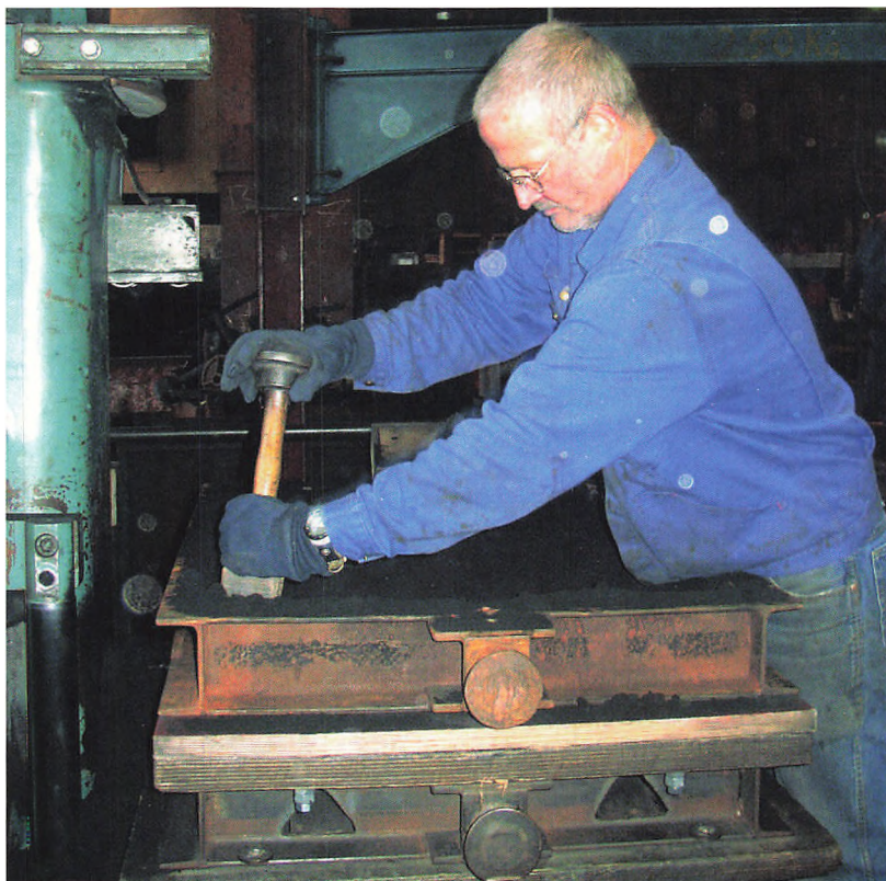
Fig. 7. En arbejdsmand på Holbæk Jernstøberi er i gang med at lave en støbeform. Han stamper det sorte støbesand fast rundt om en model, som ligger i bunden af jernrammen. Når formen er færdig kan den løftes fri af modellen og i hulrummet kan der støbes et nyt emne i jern.
