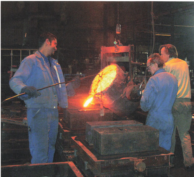
Fig. 9. Støbning på Holbæk Jernstøberi maj 2005. I dag hænger støbeskeen i en kran og tipper når støbemester drejer på et lille hjul. Hans assistenter styrer kranen og sørger for at klargøre indløbet til støbeformen. Det er stadig et varmt og beskidt arbejde at være ansat på et jernstøberi.
