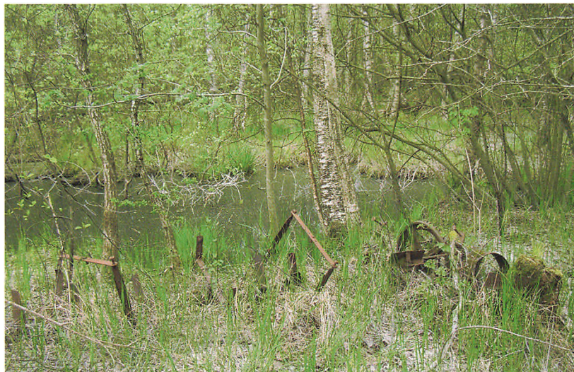
Fig. 6. Resterne af en tørvemaskine i Søndersted Lyng. Til højre ses bladene, som skræbde den våde tørvemasse op af graven, delene til venstre førte massen videre til aflæsning. Efterhånden som det store tørveeventyr i Åmosen udvikledes og senere afvikledes, blev mange maskiner kasseret og herefter overtaget af gårdmænd til produktion i mindre skala, men dog til salg – som her i sydenden af mosen. Karakteristisk er graven her også væsentligt større end de øvrige grave i nærheden. Men enkelte områder i lyngen blev udnyttet til større produktion af entreprenører; således er søen, som ligger op til Holbækvej, resterne af en kommerciel produktion.
