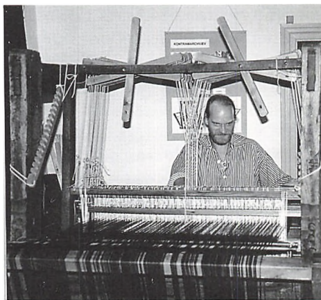
Væver Flemming Lundholm ifærd med at væve forklædestof på kontramarchvæv.
