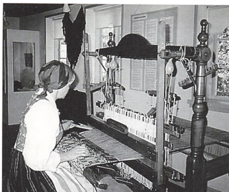
Væver Kirsten Munkholm igang med at væve beiderwand på husflidsvæven.
