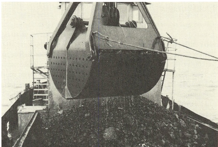
Kul graves med en special- bygget grab med et rummål på 1,8 m 3 .
