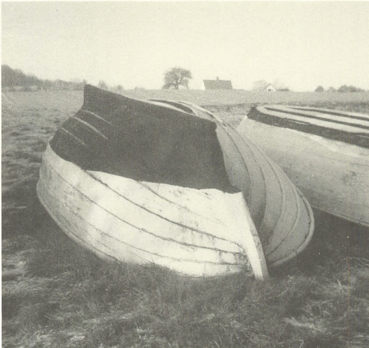
En af Frøde Hansens joller, bygget af Valdemar Bådebygger. Den er beregnet til en lille maskine, der dog aldrig blev installeret. Bemærk slid-listerne på bordkanterne. Båden bales altid på land.
