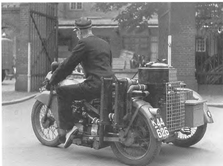
En Nimbus med micromax koksgenerator fotograferet i Aalborg i 1944.
