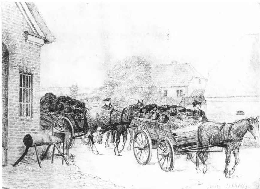
Pottemænd med hestevogn. Det ses, hvordan siderne er forhøjet med løse fjæle. Blyantstegning af Wilhelm Ferdinand Leisner (1837–1910), dateret Rødding d. 13. juli 1863. Dansk Landbrugsmuseum.
