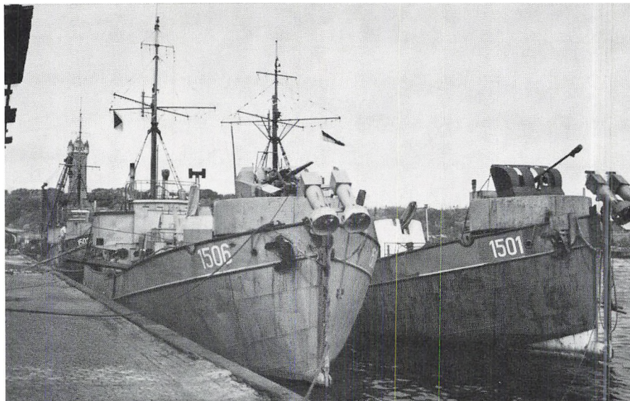
Tyske minestrygere ved Frankrigskajen. De lygtelignende instrumenter i stævnen tjente til uskadelliggørelse af akustiske miner.
