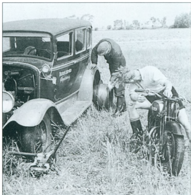
Den flotte Studebaker med det påmonterede spil på baghjulet.
