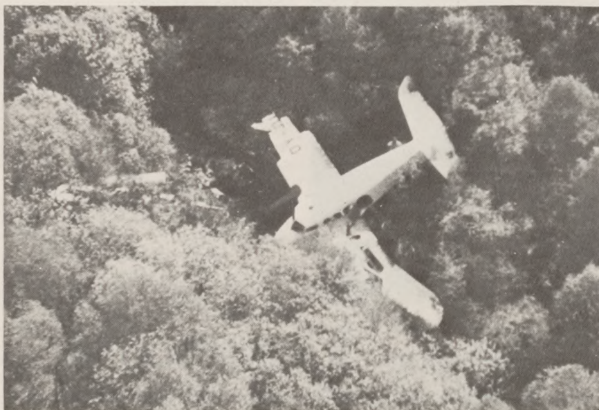
Det tidligere ambulancefly KZ IV, OY-DIZ »FOLKE BERNADOTTE«. Flyet ses liggende beskadiget i en mindre gruppe træer. Det er især gået ud over vingerne. Endvidere er understel og motorphaeng beskadiget.
