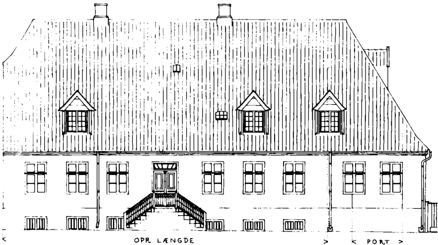
Facadetegning af sæbesyderiet og lysestøberiet, Lindegade 18, som indtil 1838 var den betydeligste fabriksvirksomhed i byen. Bolig og værksted opført 1792. De to vestre sag med port tilbygget i forrige århundrede. Facadeopmåling udført 1946 af de arkitektstuderende jvfr. s. 465. Mål 1:200.
