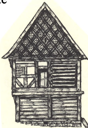
Hus fra Gotland med den ene etage kragende ud over den anden. Væggene er dels af bindingsværk dels af bulkonstruktion.
