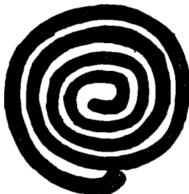
En glarmestersnegl er ganske flad og smedet i facon. Den brugtes i gammel tid, når en glaskiste skulle slibes mat. Der hældtes så vandblandet bakkensand på ruden, og sneglen kørtes rundt derpå, indtil ruden fremtrådte mat.
