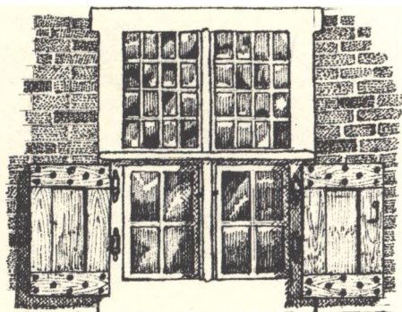
Hollandske skodder på herresædet Brecklenkamp ca. 1635.
