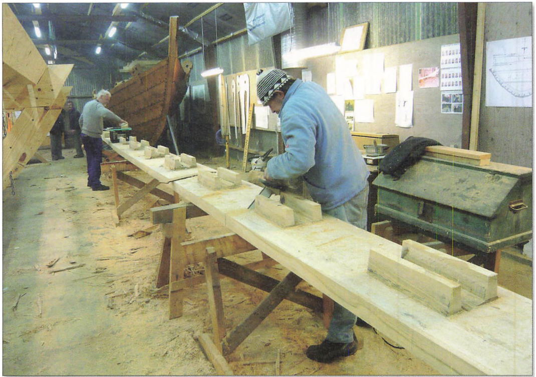
Sideplanke under fremstilling
