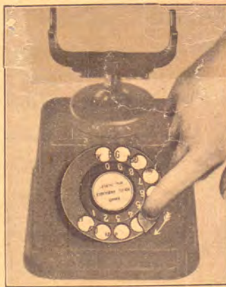
Skiven drejes i Pilens Retning, indtil Fingeren støder mod Anslaget.
