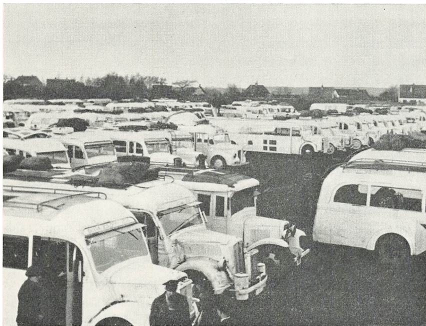
De hvide busser. – Danske rutebiler i Padborg, april 1945. På grund af benzinnanglen kørte de fleste biler med »gengas« og havde en generator (»kakkellovn«) monteret bagpå. Man fyrede med bøgeklodser, som er i sækkene på biltagene.
