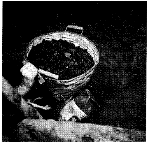
Fig. 54. Arbejdet under jorden. (II). Kullene bæres i kurve op fra minegangen. (Foto: Kaare Rasmussen. Bornholms Museum.)
