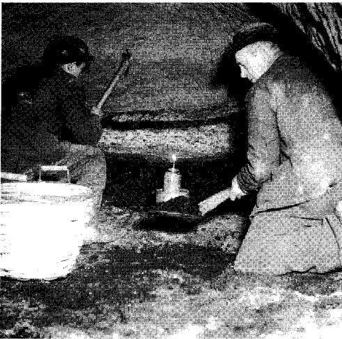
Fig. 53. Arbejdet under jorden. (I). Kullene hugges løse i en af minegangene. (Foto: Kaare Rasmussen. Bornholms Museum.)
