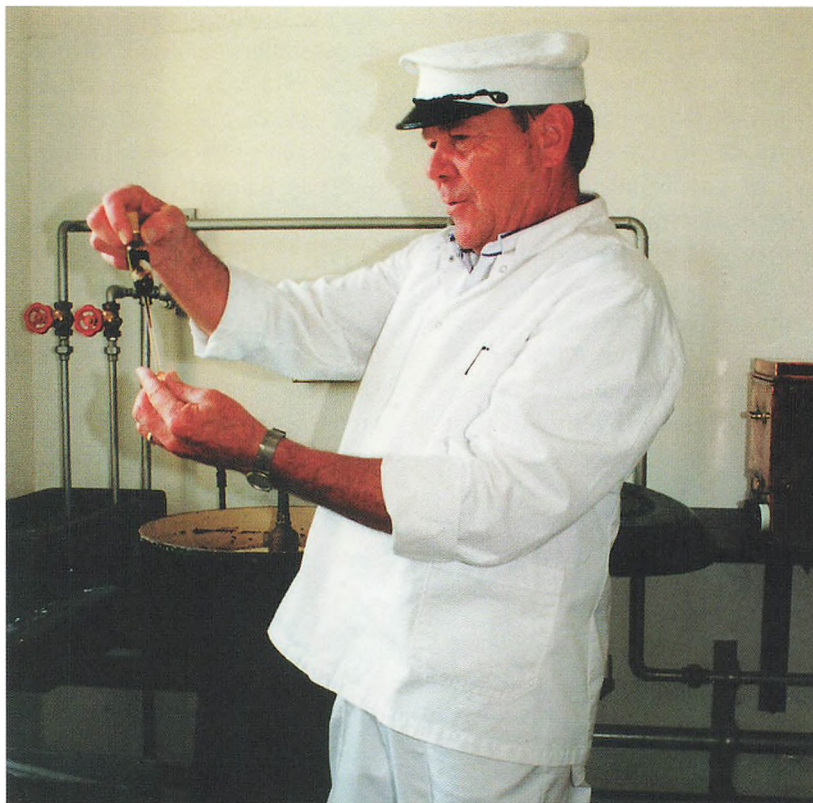
Søstrup AM i Andelslandsbyen Nyvang. Der foretages gerberering - d.v.s. undersøgelse af mælkens fedtindhold.
