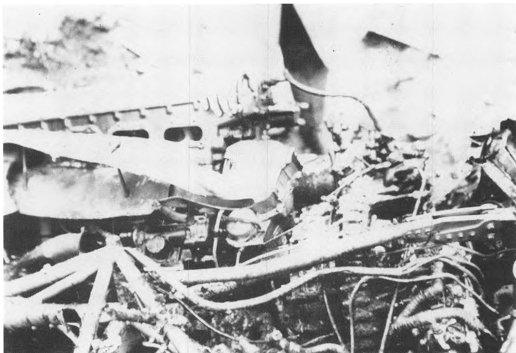
Nærbillede af flymotor fra Vornæs-flyet (Lancaster ND 365). Motoren var, som det ses, i svært beskadiget stand efter flyets eksplosion i luften med efterfølgende frit fald mod jorden. (Foto: Georg Fischer Nielsen, Lundby).
