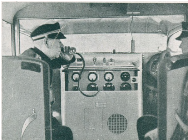
Røgdykkervogne med Radiotelefon (Københavns Brandvæsen).
