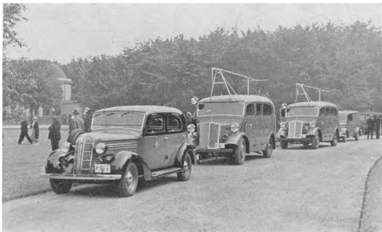
Automobilspøtje Normaltype III. Ydeevne 1200 l/Min. Vand og 500 l/Min. Skum.
