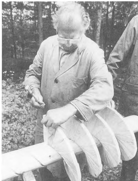
Kopi af en Archimedes-skrue fremstillet af snedker Erik Brøns, Vindemup.
