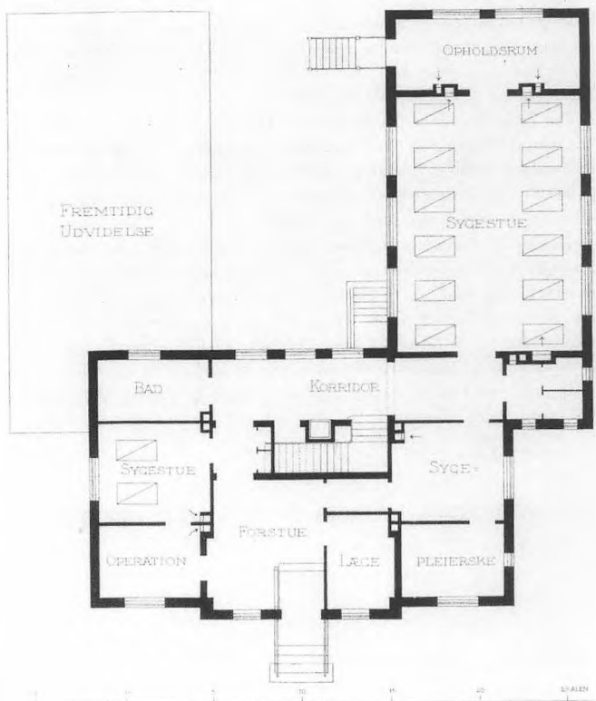
Kgl. bygningsinspektør, arkitekt J. Vilh. Petersens tegning af børnehospitalets grundplan, som den blev forelagt Odense Byråd 1898.
