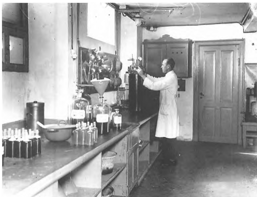
Fig. 8. Cand.pharm. Ole Kaj Constatin Hansen arbejder i kælderlaboratoriet med den lille gasfyrede autoklave til sterilisation af injektionsmedicin. Til venstre på bordet ses filtrering af opløsninger til fremstilling af hostesaft.
