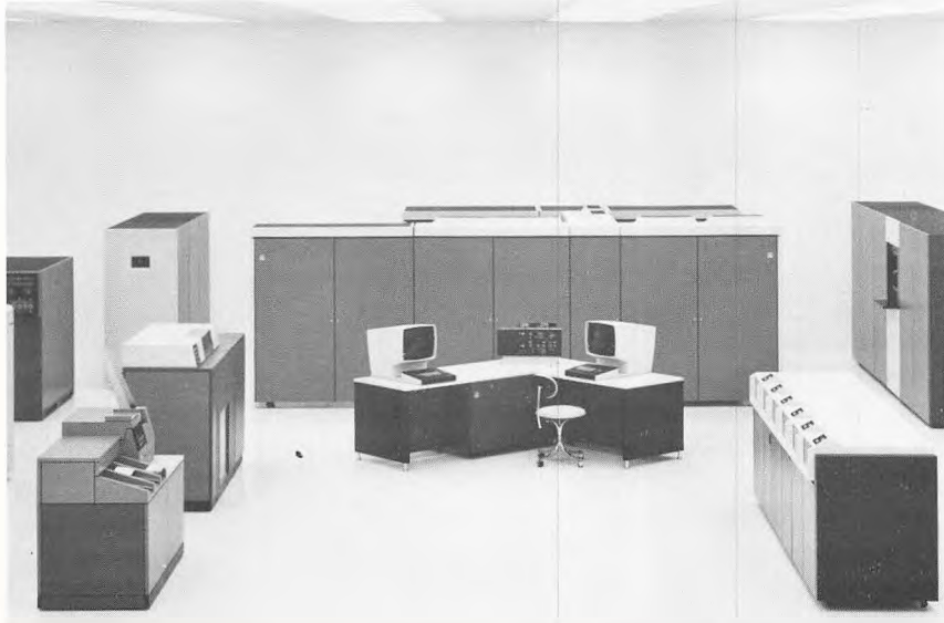
I forbindelse med udflytningen til Ejby skiftes til IBM's nyest annoncerede maskinsystem IBM 3033, der her er vist med tilhørende operatørkonsoller.
