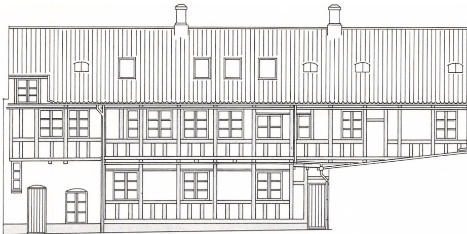
Tegning af gårdfacaden af Immervad 1. Kun 13 fag af bindingsværksfacaden er synlig. Resten af bygningen ligger op mod naboejendommen på Store Torv. Den – allerede i 1827 omtalte – 5-fags udbygning mod gården ses »under« de fire store, firkantede tagvinduer.
