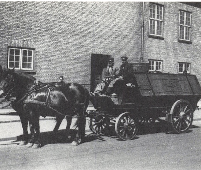
Mange vil huske denne renovationsvogn fra gadebilledet. Den forandrede sig ikke meget gennem årene. Ovenpå står to af de baljer, som blev brugt til at hælde affaldet fra skarnspandene over i. De blev båret på skuldrene ud til vognen og tømt. Hjulet til højre er til tipningen på forbrændingsanstalten. (Foto: Aage Fredslund Andersen 1934)
