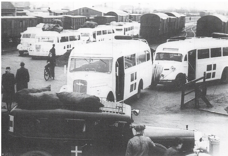
Danske hvidmalede busser i Padborg den 19. april 1945. Forrest en CBU-ambulance med generator og det hertil påkrævede udstyr. Bemærk generatoren bag på vognen og gaskøleren, som er påmonteret foran den almindelige køler. Både ambulancen og nogle af busserne har sække med generatorbrænde på taget. De to busser til venstre har desuden ekstra dæk på taget. (Foto: Frihedsmuseet).
