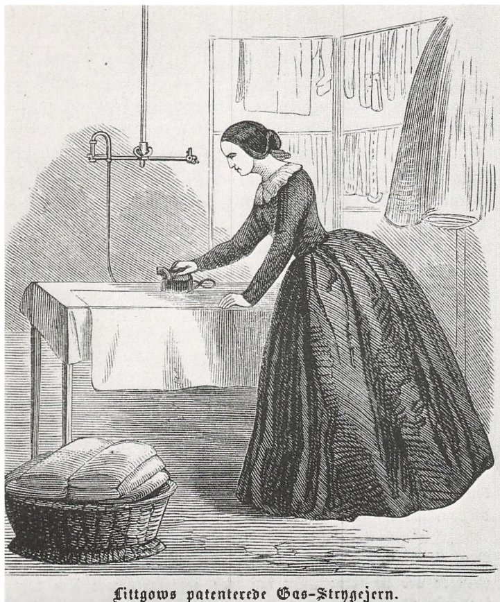
Fig. 36: 18. august 1861 bragte „Illustreret Tidende“ en omtale af det nyopfundne amerikanske gasstrygejern „til Fordeel for alle de Damer, som have at gjøre med at skaffe reent Tøi tilveie“. Strygejernet tilsluttedes gashanen med en lang slange, der endte i et gaffelformet jernrør med fine sideåbninger i det hule strygejern. Om deres udbredelse vides intet. I „Husmoderen“ fra 1885 nævnes, at strygejern kan opvarmes ved gas over en „egen, dertil konstrueret Strygerist“.
