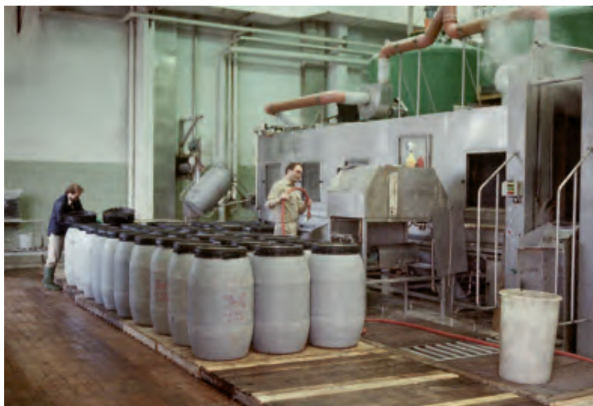
Figur 6. LEO Pharmas heparinfabrik i Esbjerg, hvortil produktionen blev flyttet i 1976. Billedet viser beholdere med svinemucosa, hvorfra heparinet isoleres (LEO Pharma A/S).
