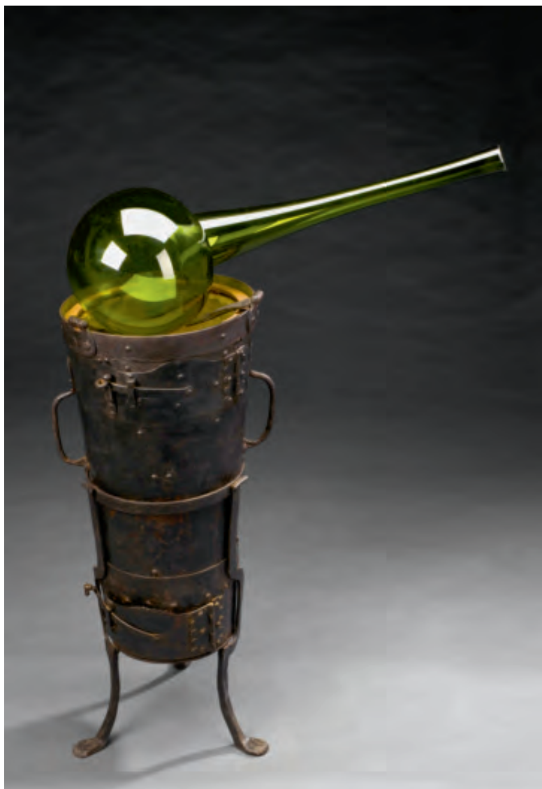
Dette fyrsted blev sandsynligvis brugt til at opvarme stoffer under kemiske eksperimenter. Det er formet som en høj konisk cylinder på tre ben med ydersiden lavet af jern og med en foring af chamottesten. Sandsynligvis fremstillet i England. Her vist med en svanehals glasretort (A630052). (Foto: Science Museum, London, Wellcome Images, L0058286)
