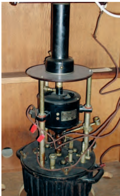
Figur 6. Roterende kviksølvaafbryder. Midt i billedet ses en elektromotor. Motorens lodrette akse fortsætter ned i en beholder med kviksølv og ender i en snegl, der suger kviksølv op og slynger det ud mod kontaktpunkter på beholderens inderside. Beholderen gennemstrømmes af belysningsgas for at holde luftens ilt væk. Gassen kan også bruges til at opvarme røntgenrøret som led i regulering af luft trykket i røntgenrøret. Medicinsk Museion. (Foto: Sven Erik Hansen)
