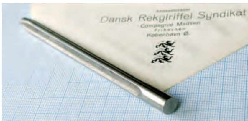
Figur 6. Søm nr. 1, prøveeksemplar af kirurgisk søm fra DISAs produktion. Det er uden afsat hoved og uden langsgående kanal, formentlig fremstillet som et eksempel for at demonstrere fremstillingsmetoden.
