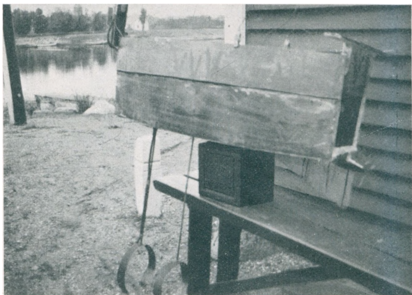
En „Storm P.do“. Bemærk Skruen, Styr, Akkumulatoren og Indretning til Fastgørelse af Bomben, der er beregnet til at møde Skibssiden og eksplodere ca. en Meter under Vandlinjen.
