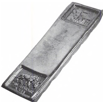
Da Det forenede Dampskibsselskabs S/S Frederik VIII i 1926 skulle repareres, afgav rederiet ordre på 6.000 kg lejemetal af en legering, som Svend Bergsøe selv havde komponeret og døbt »Frederik VIII-metal«. Det var fabrikkens hidtil største ordre. Her ses en barre af metallet, forsynet med firmaets logo.
