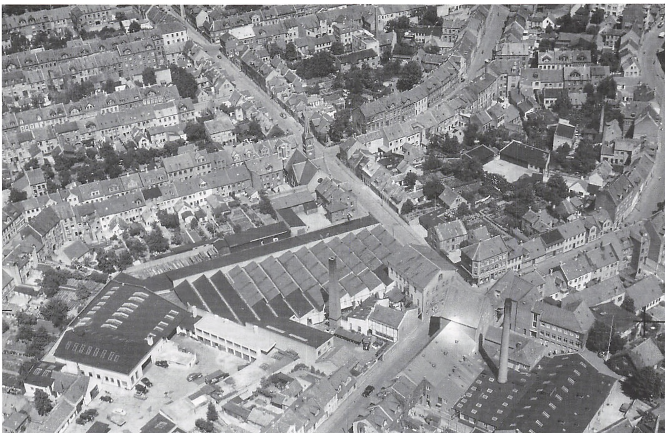
Bierfreunds gamle væverbygning fra 1870 på hjørnet af Odinsgade ses endnu på dette luftfoto fra lige efter 2.verdenskrig. Det store shed-anlægs savtakkede tagværker dominerede nu fabriksområdet (Aero, København, fot., Stadsarkivet).
