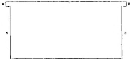
Fig. 50. Indstudsbor til et enkelt Trugstade. n n ere de fremstaaende Enden, der hvile paa Metallisterne. s s de to Rander, som ved Indboringen beklædes med Tøj.
