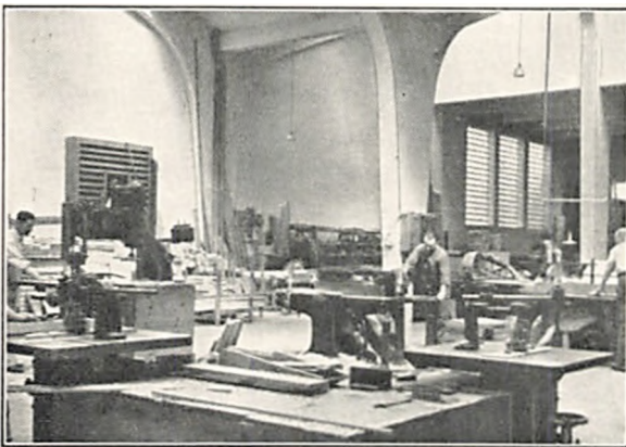
Fig. 138. Maskinsnedkeriet. Alle Transmissioner er anbragt under Gulvet
