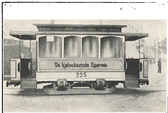
Fig. 85. Hestesporvogn ombygget til Bivogn
