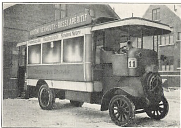
Fig. 115. Ombygget »De Dion Bouton«-Omnibus af den fra Frederiksberg Sporveje overtagne Type
