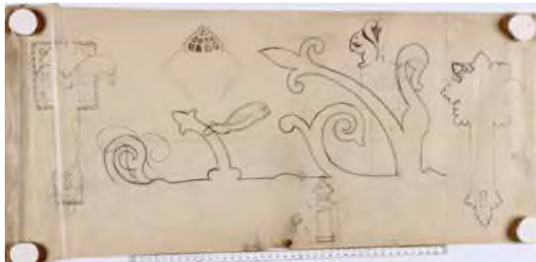
Figur 92. Udkast til beslag og dørhåndtag på knopdør samt indvendige døre. Hovedmotivet er udkast til beslag til knopdøren ved siden af trappetårnet og dørgreb til indvendige døre. Foto: Per Bay Lund/Roskilde Kloster [F25].
