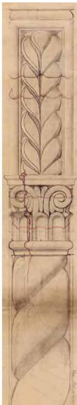
Figur 87. Søjle i trappegang. Ornamenteringen er angivet med profildybde til snedker eller billedskærer. Foto: Per Bay Lund/Roskilde Kloster [F06].
