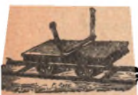
Wagon, Type 60, forsynet ed en bevægelig Fork til Transport af store Træer.
