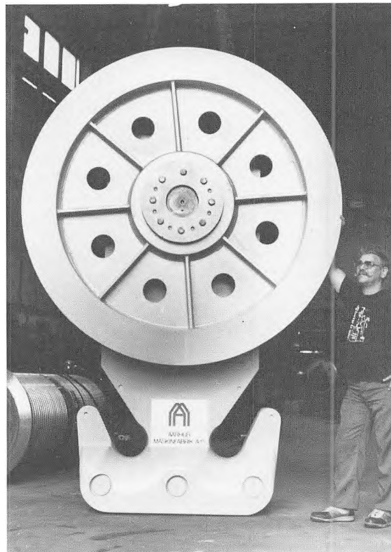
At Århus Maskinfabrik har specialiseret sig i kran- og løseudstyr i store størrelser giver billedet her et godt eksempel på. Den 12 tons tunge krog skal anvendes på en boreplatform i Nordsøen, hvor den skal kunne løfte ikke mindre end 550 tons. (Foto: Dan Jakobsen).
