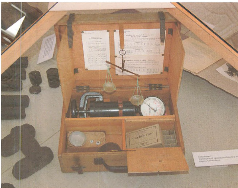
Fig. 1. Carbidmeter i kuffert (fra udstilling på Kalundborg Museum). Selve carbidmeteret ligger fastspændt i kufferten; vægten hænger klar til afhøvet tørv. Foto Anne-Mette M. Andersen.
