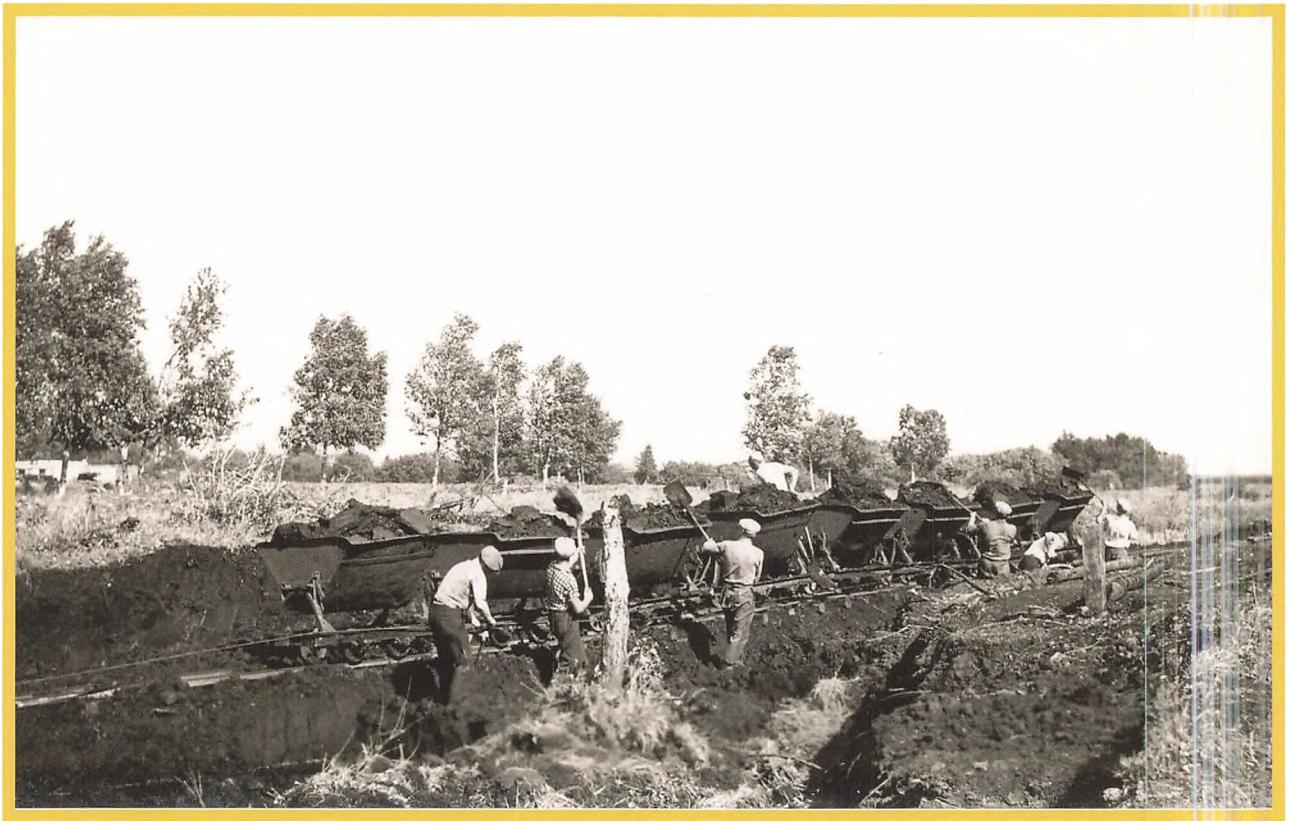
Tørv på togvogne. Kilometervis af jernbanespor blev lagt ud i Store Åmose for at effektivisere produktionen, den videre transport til nærmeste station og derfra til København. Tørvegravningen har gjort sit til, at mosernes landskaber har ændret sig markant. Gamle kort afspejler mange historier om landskabets udvikling. Foto Åmosemuseerne.
