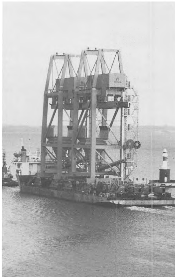
Tilsyneladende i magsvejr forlod dette hollandske sværgodsskib Århus med to kæmpekraner fra Århus Maskinfabrik til Vestkraft i Esbjerg fastsvejet til dækket. Søgangen var dog voldsom, ikke blot før og på turen, hvad der gav leveringsforsinkelser. Men opstillingen i Esbjerg voldte vanskeligheder, der kostede firmaet 8-10 mio. kr. og medvirkede til, at direktøren for den i øvrigt stærkt voksende virksomhed - fra 44 mio. i 1988 til 108 i 91 - fratrådte kort efter årsskiftet. (Foto: Preben Hupfeldt)
