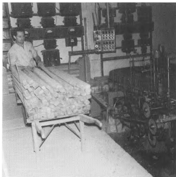
Her er det nye fuldautomatiske afskærerbord til højre i billedet, der ved hjælp af nogle buede messingskinner og et lille lamelbånd trækker stenene ud på hylderne, det er Knud Overgaard (Ågård) der passer maskinen og lægger lægter (hylder) i lægtemagasinet.
