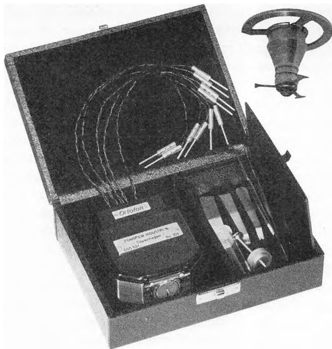
Fig. 2. Dette skærehoved til fremstilling af stereofoniske gramfonoplader er et højt udviklet specialprodukt i elektronisk og finmekanisk henseende. Det ene af de to sammenkoblede svingendesystemer ses til højre. I denne del indgår så vanskeligt bearbejdelige metaller som fuldt varmebehandlet duraluminium, titan og berylliumbronze, fordi man med disse materialer opnår den rette kombination af ringe egenvægt, styrke og elastiske egenskaber. I hele skærehovedet indgår godt et dusin forskellige metaller. (A/S Fonofilm).
