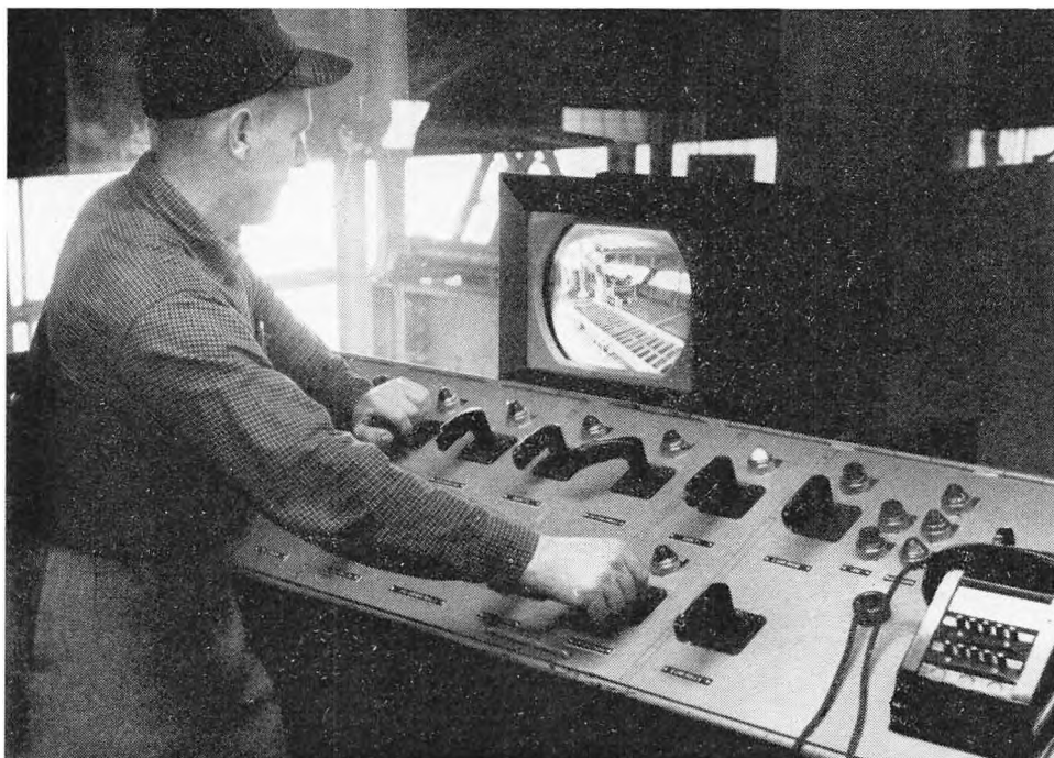
Fig. 4. Fjernsynet benyttes også i industrien, bl. a. på arbejdspladser, hvor direkte kontrol er vanskelig eller farlig. Billedet stammer fra et amerikansk valseværk.
