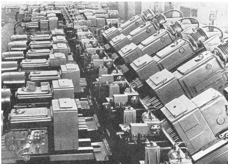
Fig. 12. Maskingade med transferanlæg og automater fra sovjetrussisk motorfabrik. Man ser, at bearbejdningen af emnerne finder sted fra begge sider, og iøvrigt bemærker man de store elektromotorer, der driver hver automat. Ofte er disse motorer således indrettet, at de automatisk kobler fra ved ekstraordinær stor belastning, som f. eks. ved slitage af værktøjer, fejl i materialet i de emner, der bearbejdes, etc.
