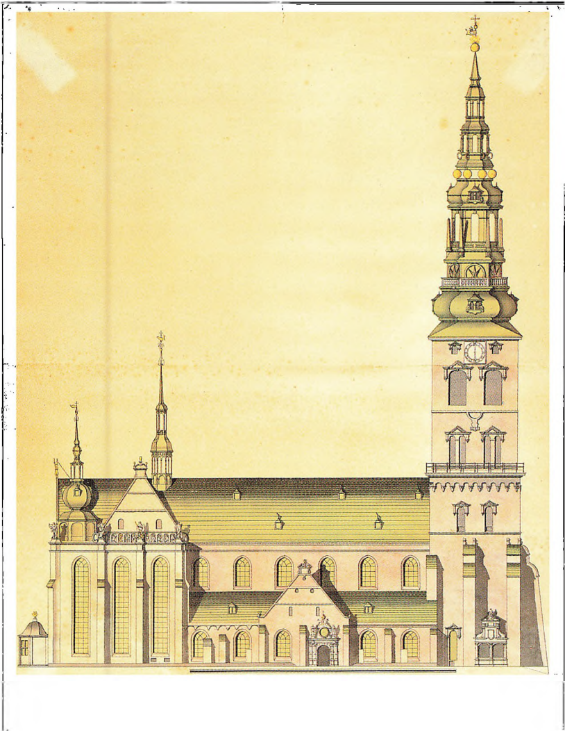
Opmålingstegning af Nikolaj Kirkes nordside, udført engang i 1700-tallet. Mellem tårnets stræbepiller ses benhuset (Københavns Bymuseum).
